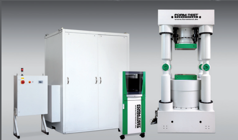
12 MN Prüfanlage zur Kalibrierung von Kraftaufnehmern
