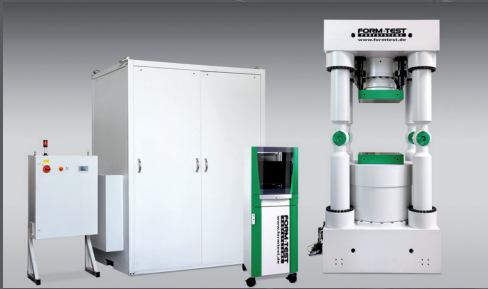
12 MN Prüfanlage zur Kalibrierung von Kraftaufnehmern
